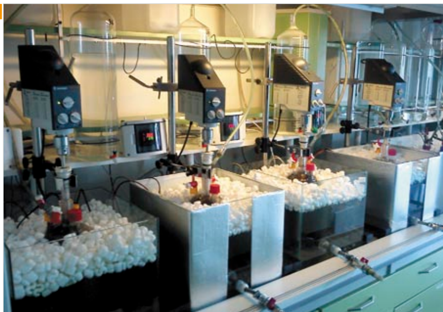
Zestaw fermentorów do badań symulacyjnych – laboratorium biotechnologiczne firmy Biogaz Zeneris (Archiwum Laboratorium Biogaz Zeneris)
